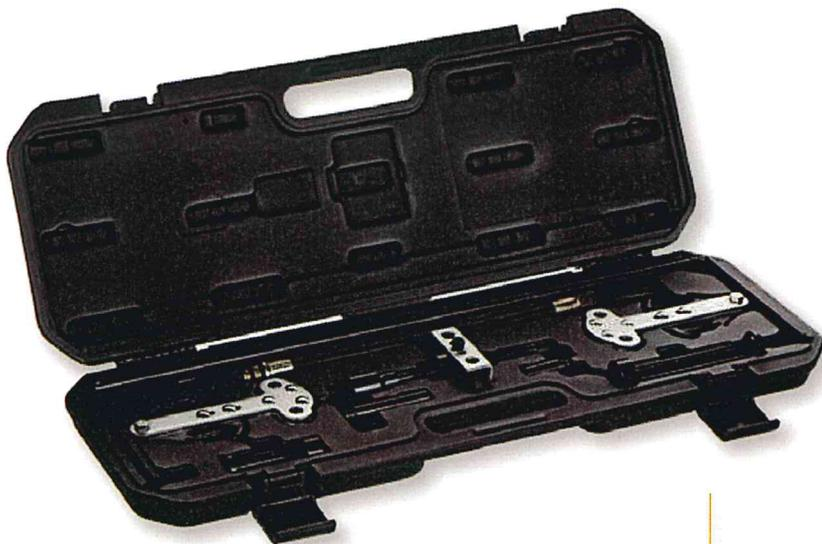
Utensile montaggio e smontaggio molle valvola
