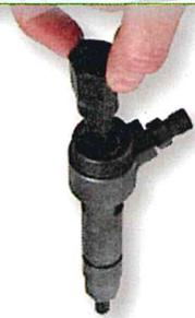
Bussole rimozione connessione elettrica
