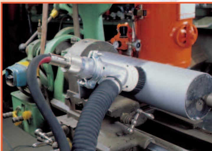
Sabbatura di cilindri a seguito di lavorazioni meccaniche su tornio. Per questo tipo di applicazione, è possibile automatizzare il ciclo di sabbatura bloccando la testa a spazzola in prossimità della torretta portautensili.
