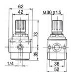
Attacchi **R50/14** (1/4" gas) **R50/38** (3/8" gas) 24 bar Pressione in entrata Pressione in uscita 0 ÷ 12 bar 630 g Peso R50 / 14 Attacchi 1/4" 42131563 R50 / 14 SM Attacchi 1/4"
