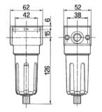
**F50/14** (1/4" gas) **F50/38** (3/8" gas) Attacchi Capacità coppa 60 cc 35 cc Zona impurità Grado di filtrazione 40 ս 590 g
