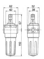
L50/14 (1/4" gas) L50/38 (3/8" gas) Attacchi Capacità coppa Max livello olio 60 cc 50 cc
