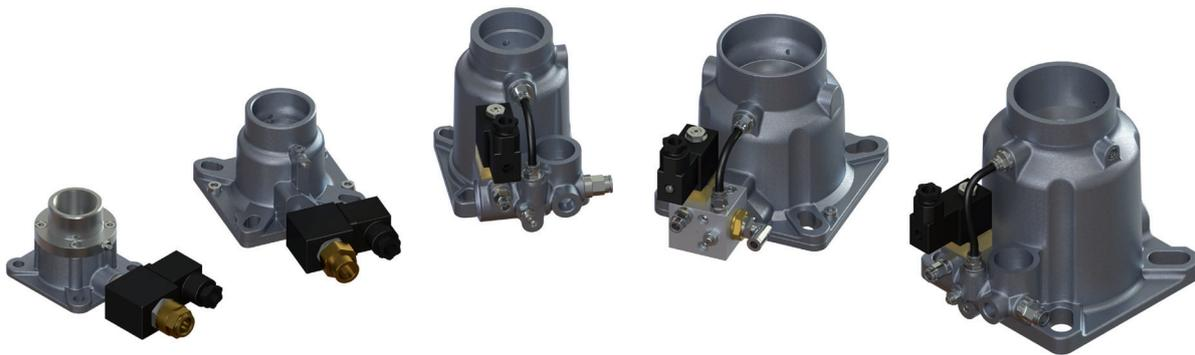
**APPLICAZIONE:** Installato all'ingresso del compressore per controllare la sua capacità. All'avvio, la valvola rimane aperta fino a quando la pressione di aspirazione minima chiude la valvola. Durante il normale funzionamento, la valvola si apre e si chiude in risposta a un segnale che soddisfa la richiesta di aria. All'arresto, una valvola di ritegno rimane chiusa e mantiene l'aspirazione. La valvola è disponibile anche nella versione non ritorno e proporzionale.
