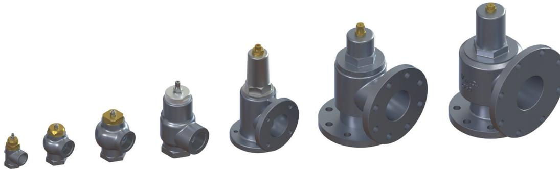
**APPLICAZIONE:** La valvola di minima pressione, installata dopo il separatore dell'olio, ha due funzioni: • durante l'avviamento, la valvola rimane chiusa fino alla pressione di apertura; quindi si apre per mantenere la pressione minima nel separatore aria-olio (in questo modo, la pressione può lubrificare l'unità del compressore); • durante lo spegnimento, la valvola di ritegno è chiusa per impedire il riflusso dalla linea attraverso il compressore.
