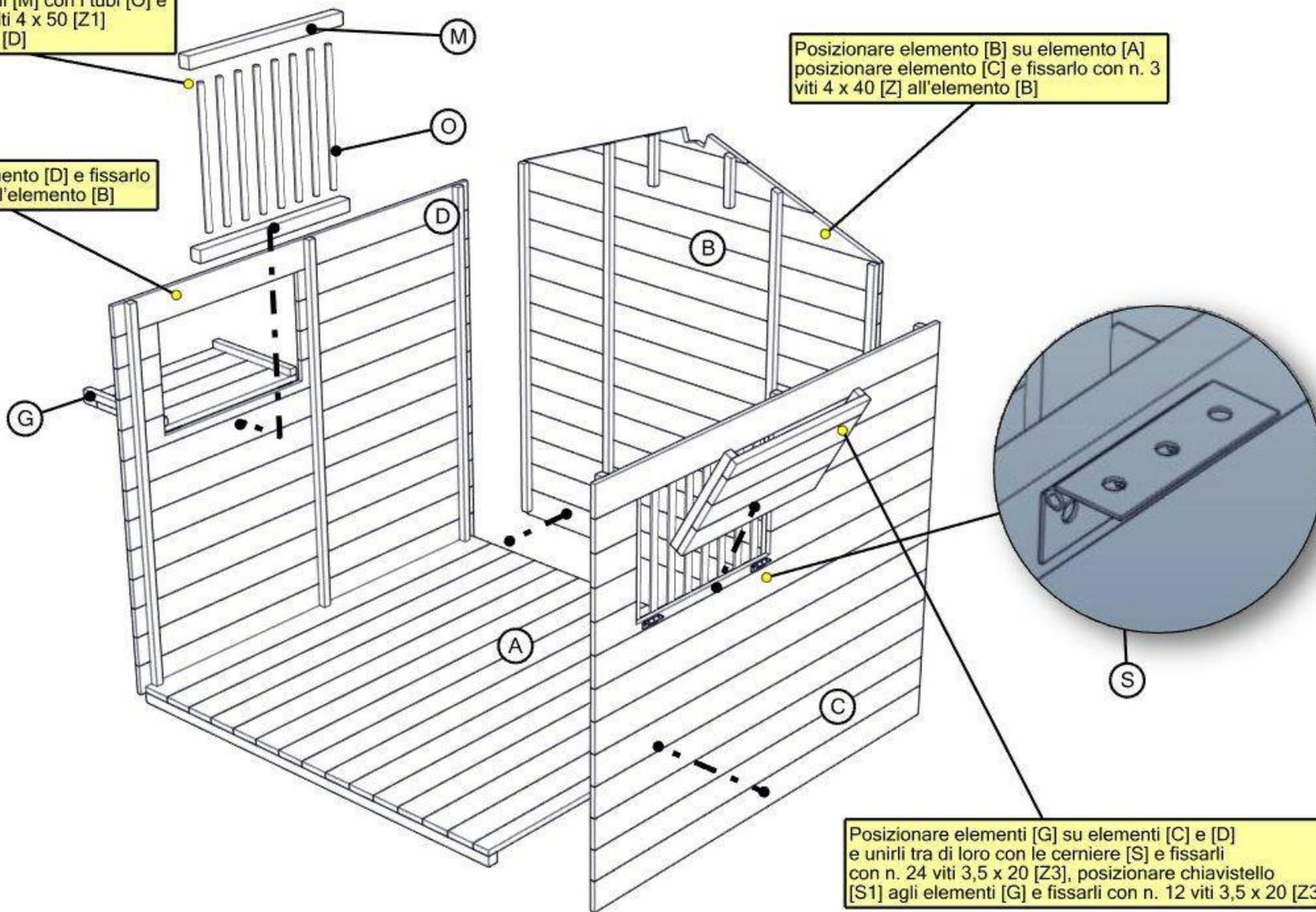
Posizionare elementi [G] su elementi [C] e [D] e unirli tra di loro con le cerniere [S] e fissarli con n. 24 viti 3,5 x 20 [Z3], posizionare chiavistello [S1] agli elementi [G] e fissarli con n. 12 viti 3,5 x 20 [Z3]
