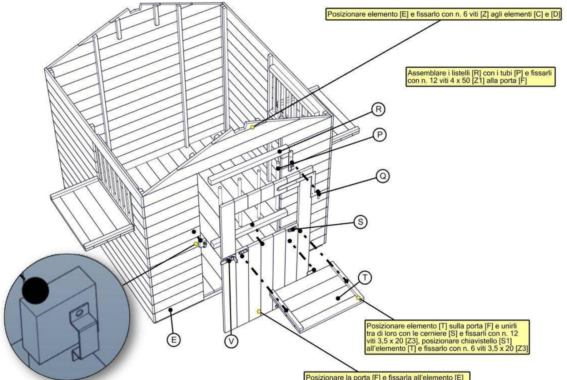
Posizionare elemento [E] e fissarlo con n. 6 viti [Z] agli elementi [C] e [D]
