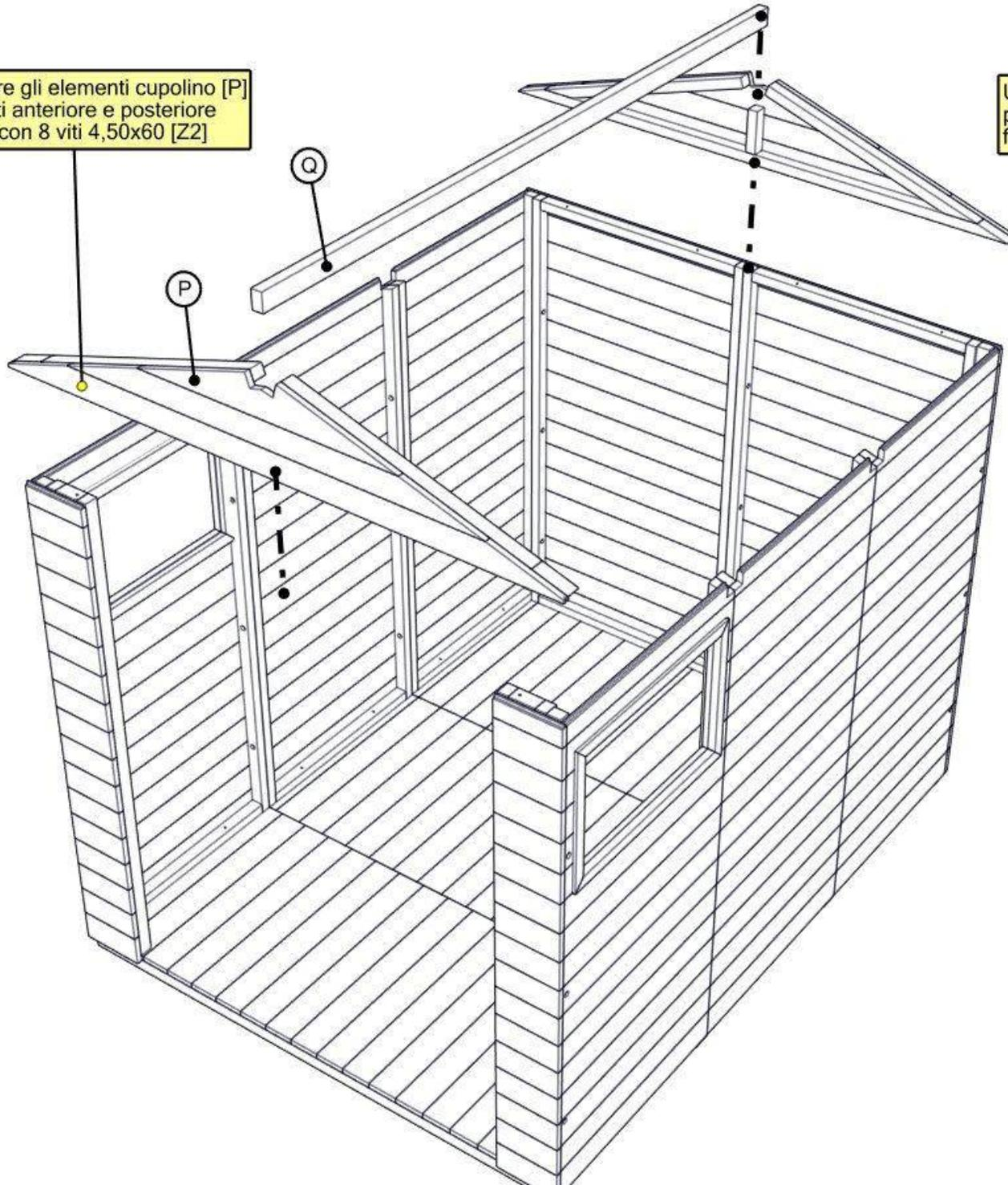
Posizionare Elemento tetto destro [M] nella parte posteriore DX della casetta e quello SX [N] nella parte posteriore della casetta posizionate le falde tetto centrale [O] e fissarle con 6 bulloni 8x80 posizionare Elemento tetto [M] nella parte anteriore SX della casetta e quello [N] nella parte anteriore DX con 6 bulloni [Z4]
