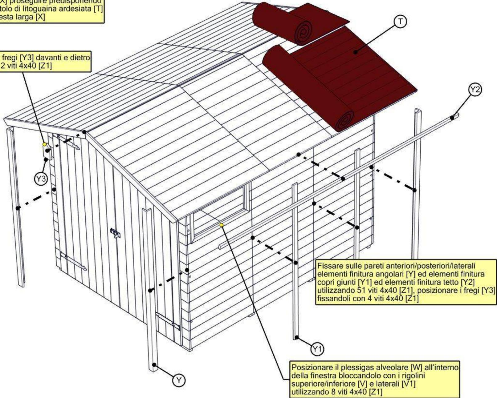
Fissare sulle pareti anteriori/posteriori/laterali elementi finitura angolari [Y1] ed elementi finitura copri giunti [Y2] ed elementi finitura tetto [Y2] utilizzando 51 viti 4x40 [Z1], posizionare i fregi [Y3] fissandoli con 4 viti 4x40 [Z1]
