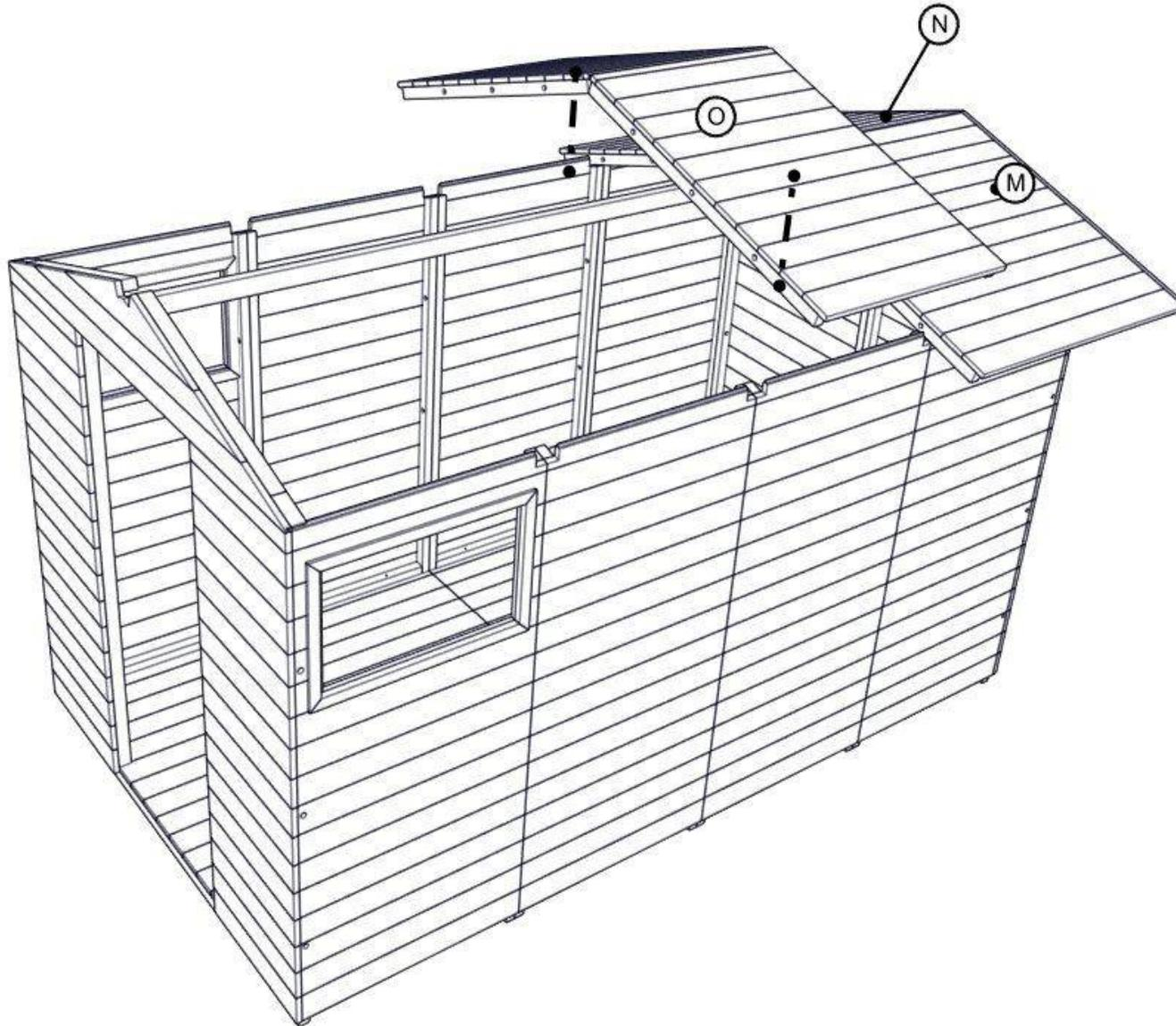
Posizionate le falde tetto centrale [O] e fissarle con 6 bulloni 8x80 alle falde del tetto [O], posizionare elemento tetto [M] nella parte anteriore SX della casetta e quello [N] nella parte anteriore DX e fissarle alle falde del tetto [O] con 6 bulloni [Z4]
