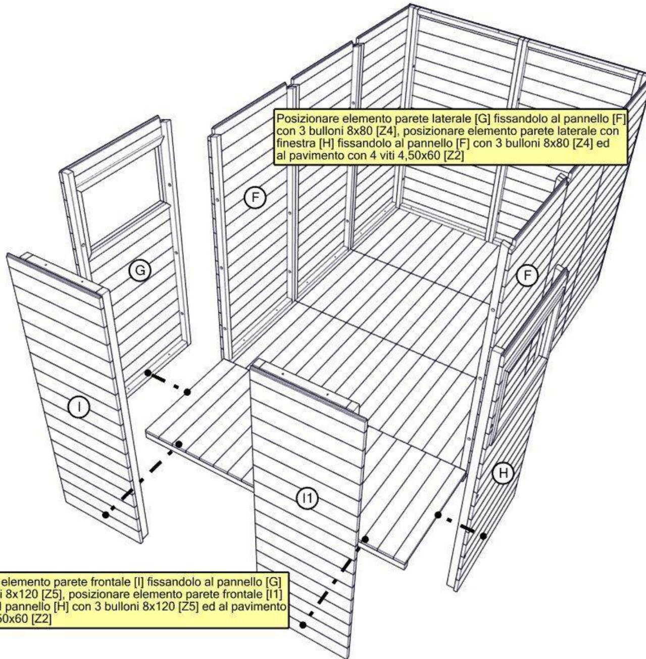
Posizionare elemento parete laterale [G] fissandolo al pannello [F] con 3 bulloni 8x80 [Z4], posizionare elemento parete laterale con finestra [H] fissandolo al pannello [F] con 3 bulloni 8x80 [Z4] ed al pavimento con 4 viti 4,50x60 [Z2]
