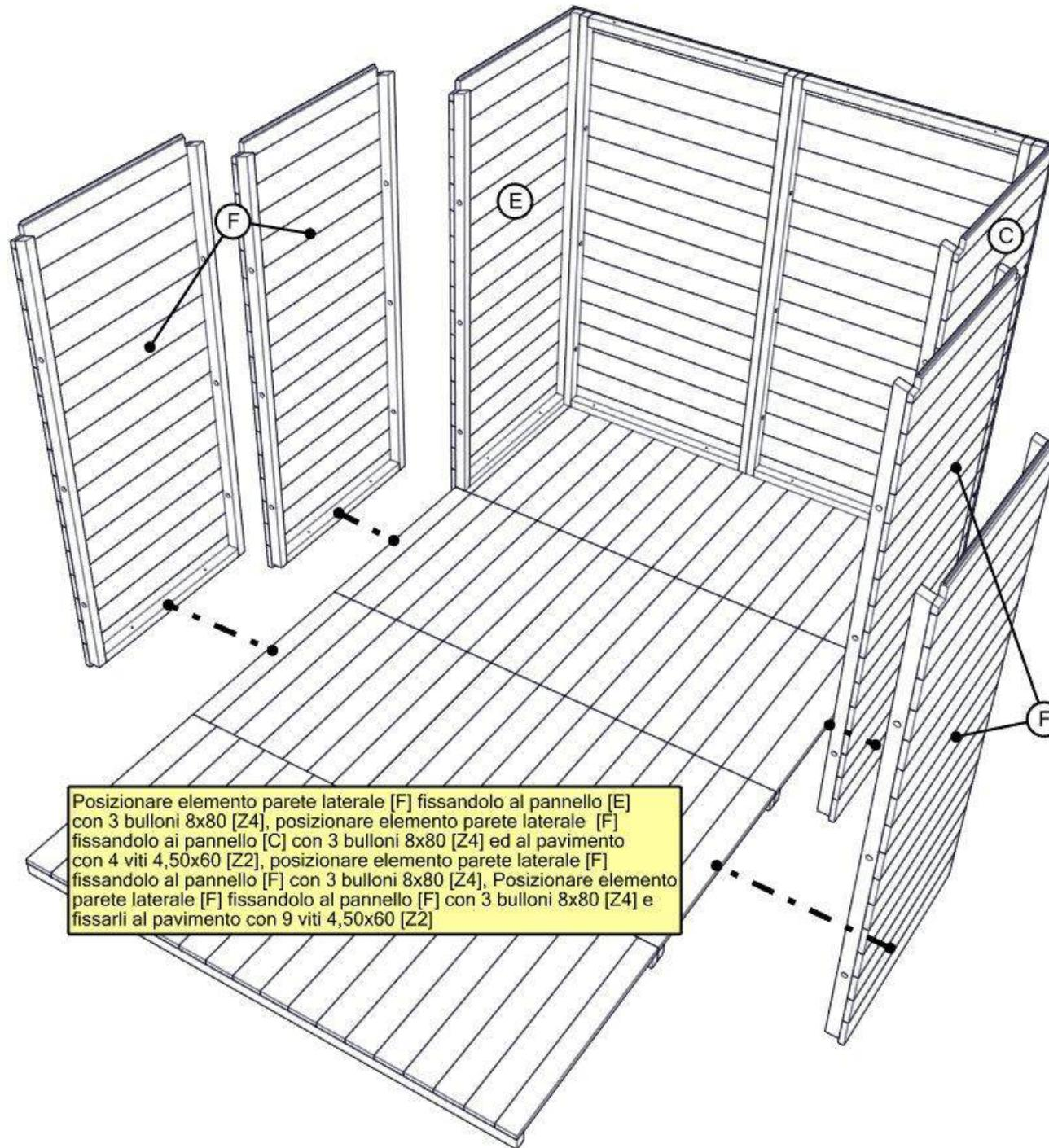
Posizionare elemento parete laterale [F] fissandolo al pannello [E] con 3 bulloni 8x80 [Z4], posizionare elemento parete laterale [F] fissandolo ai pannello [C] con 3 bulloni 8x80 [Z4] ed al pavimento con 4 viti 4,50x60 [Z2], posizionare elemento parete laterale [F] fissandolo al pannello [F] con 3 bulloni 8x80 [Z4], Posizionare elemento parete laterale [F] fissandolo al pannello [F] con 3 bulloni 8x80 [Z4] e fissarli al pavimento con 9 viti 4,50x60 [Z2]
