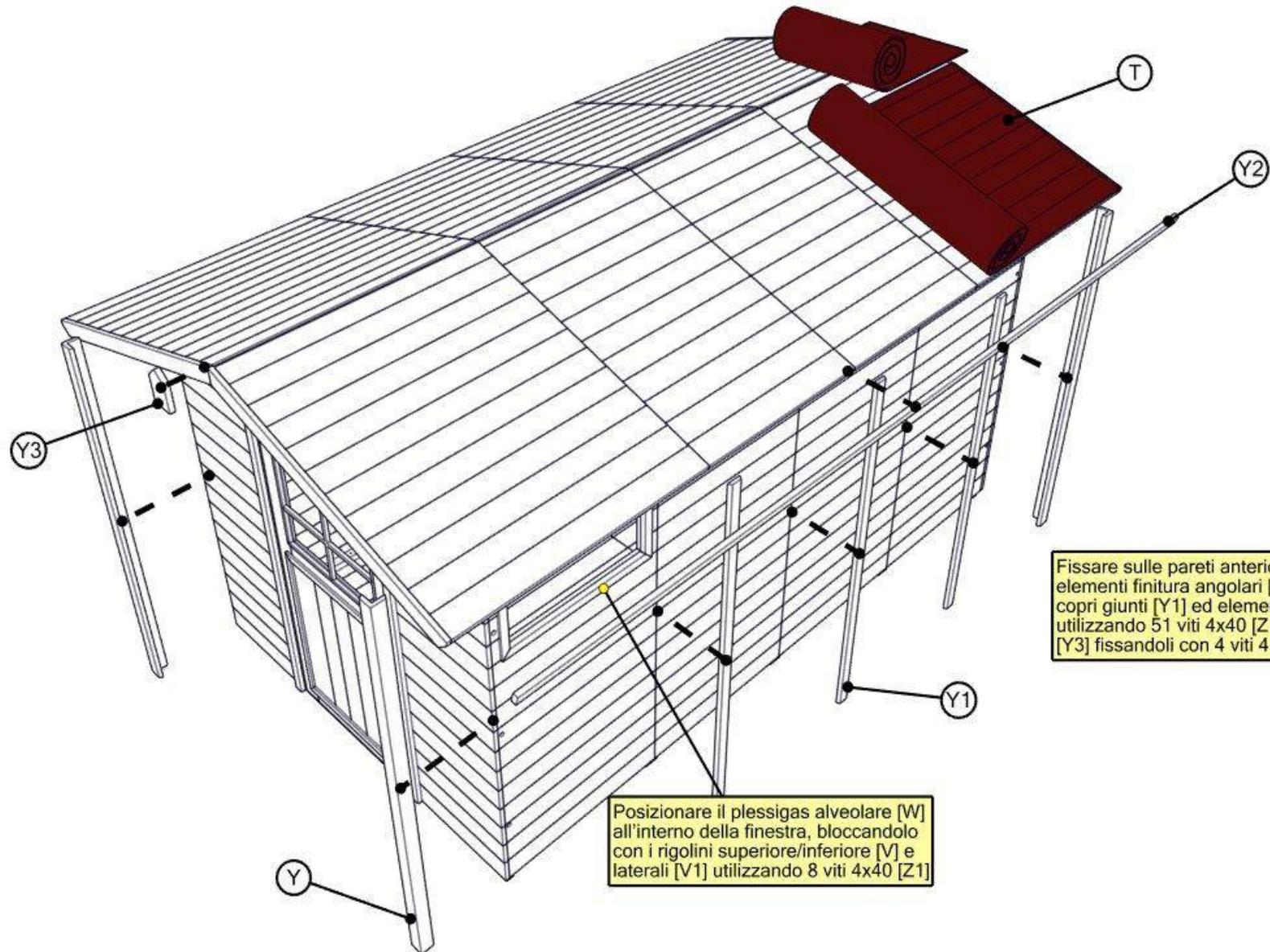
Fissare sulle pareti anteriori/posteriori/laterali elementi finitura angolari [Y] ed elementi finitura copri giunti [Y1] ed elementi finitura tetto [Y2] utilizzando 51 viti 4x40 [Z1], posizionare i fregi [Y3] fissandoli con 4 viti 4 x 40 [Z1]
