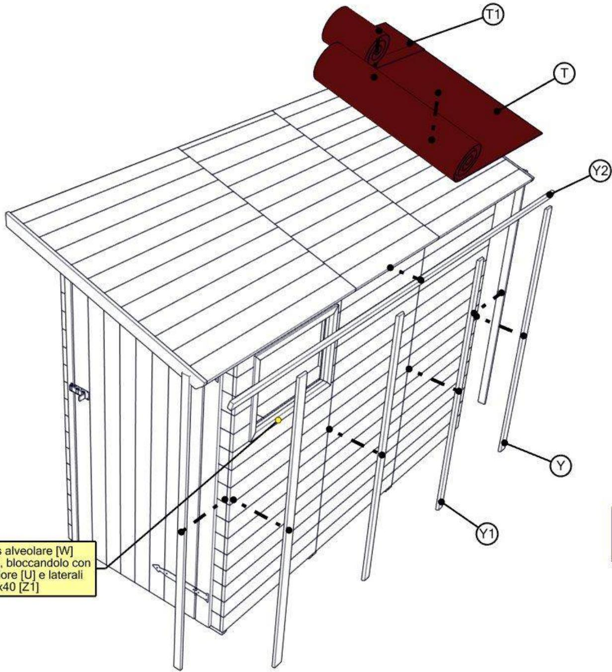
Posizionare il plessigas alveolare [W] all'interno della finestra, bloccandolo con i rigolini superiore/inferiore [U] e laterali [U1] utilizzando 8 viti 4x40 [Z1]
