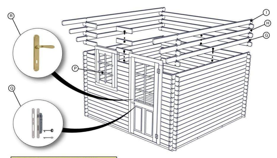
Posizionare e incastrare elementi perlina [G/H/I] incastrandoli con elementi perlina [D/E], togliere i rigolini fermavetro posizionare il plexiglass e riposizionare i rigolini [P] e fissarli con i chiodi, inserire la serratura [Q] nella sede e fissarla con due viti 4x 40 [Z3], fissare la maniglia [R] con 6 viti 3,5 x 20 [Z5] e fissare il contrastro [S] serratura sul montante porta fissandolo con 2 viti 4x 40 [Z3]
