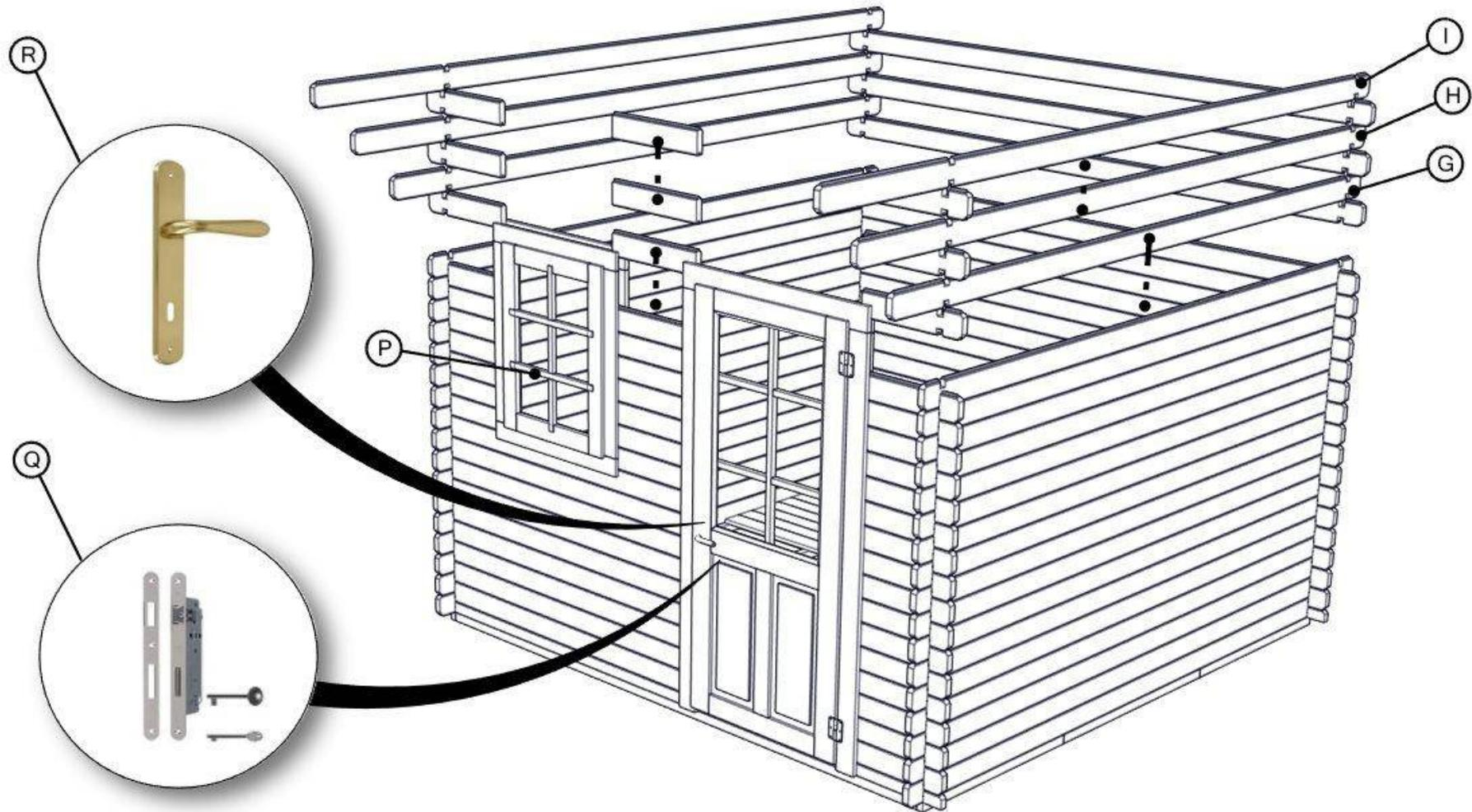
Posizionare e incastrare elementi perlina [G/H/I] incastrandoli con elementi perlina [D/E], togliere i rigolini fermavetro posizionare il plexiglass e riposizionare i rigolini [P] e fissarli con i chiodi, inserire la serratura [Q] nella sede e fissarla con due viti 4x 40 [Z3], fissare la maniglia [R] con 6 viti 3,5 x 20 [Z5] e fissare il contrasto [S] serratura sul montante porta fissandolo con 2 viti 4x 40 [Z3]
