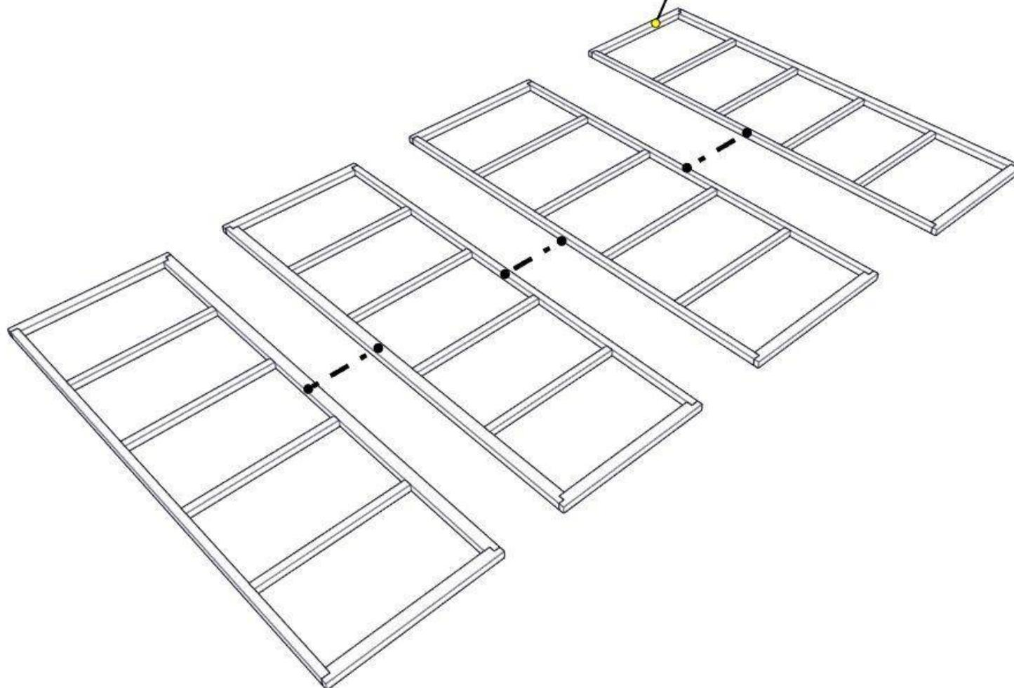
Posizionare elementi perlina [B/B1/C] fissandoli al telaio pavimento [A] con 4 viti 4,50x60 [Z1]
