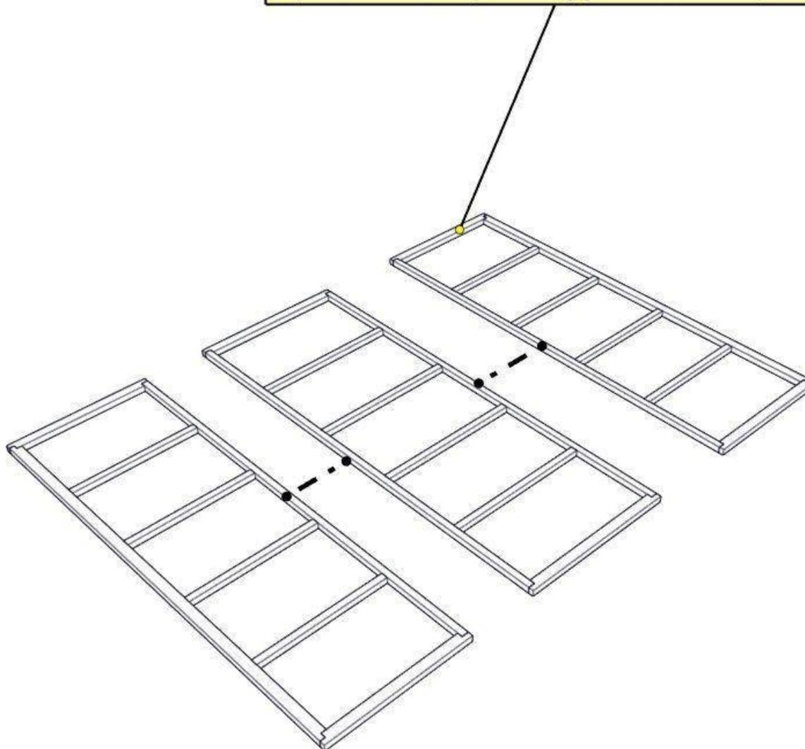
Posizionare elementi perlina [B/B1/C] fissandoli al telaio pavimento [A] con 4 viti 4,50x60 [Z1]
