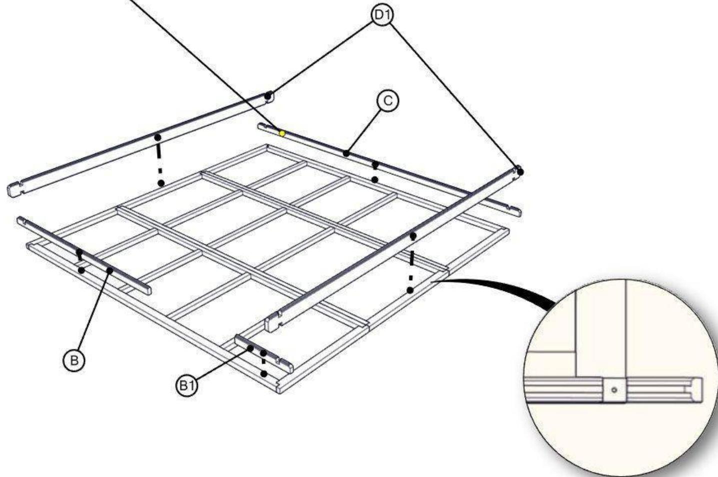
Posizionare e incastrare elementi perlina [E/D/D1] per 6 strati iniziando con l'elemento perlina frontale [E] a DX poi con l'elemento perlina [D1] laterale, [D] posteriore, [D1] laterale ed infine l'elemento frontale SX [E1]
